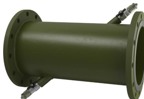
Однолучевой УПР DN300 из углеродистой стали с фланцевым присоединением PN16 и возможностью замены ПЭП без опорожнения трубопровода
