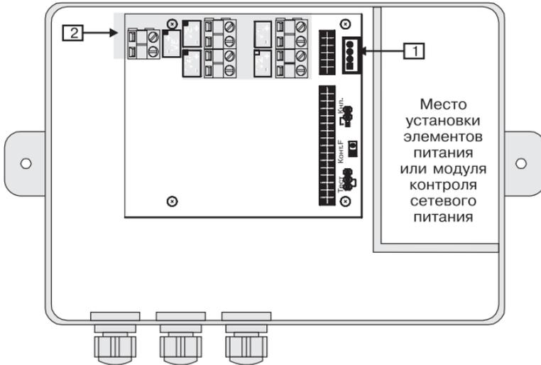
**Рисунок Б.6 – Внешний вид монтажного отсека вычислителя «Эльф-05»**
