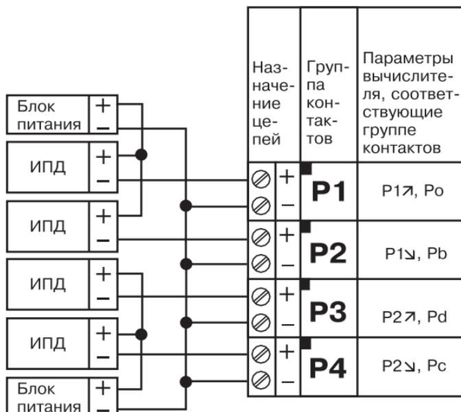
**Рисунок Б.10 – Схема подключения ИПД к вычислителю.**
