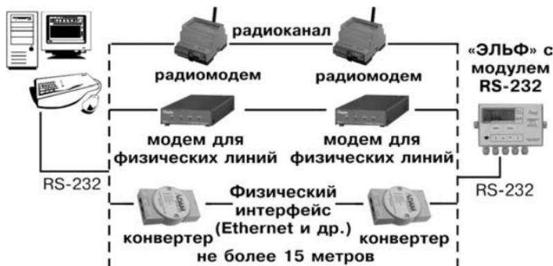
**Рисунок 1.1** Варианты применения интерфейсного модуля RS-232
