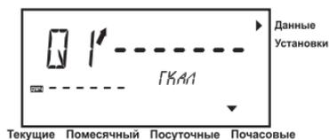
**Рисунок 2.5 - Экран ЖК-дисплея в случае отсутствия требуемой для просмотра архивной записи**
