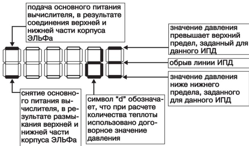
**Рисунок 2.11 - Расшифровка кодов причин нештатной ситуации, отображаемой в поле дополнительной информации, при измерении давления.**
