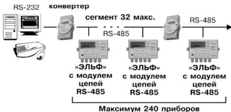
**Рисунок 1.2** Варианты применения интерфейсного модуля RS-485
