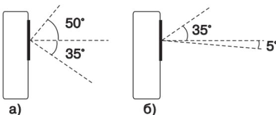
**Рисунок 3.1 - Угол просмотра ЖК-дисплея вычислителя «ЭЛЬФ»**
