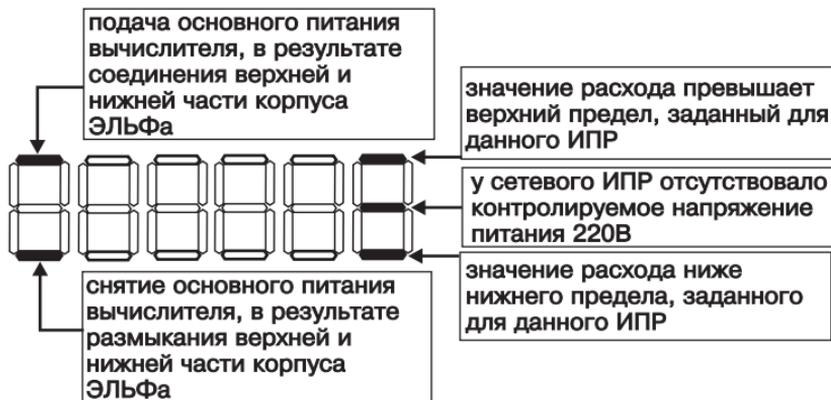
**Рисунок 2.10 - Расшифровка кодов причин нештатной ситуации, отображаемой в поле дополнительной информации, при измерении объемного (массового) расхода.**
