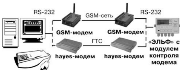
**Рисунок 1.3** Варианты применения интерфейсного модуля контроля модема
