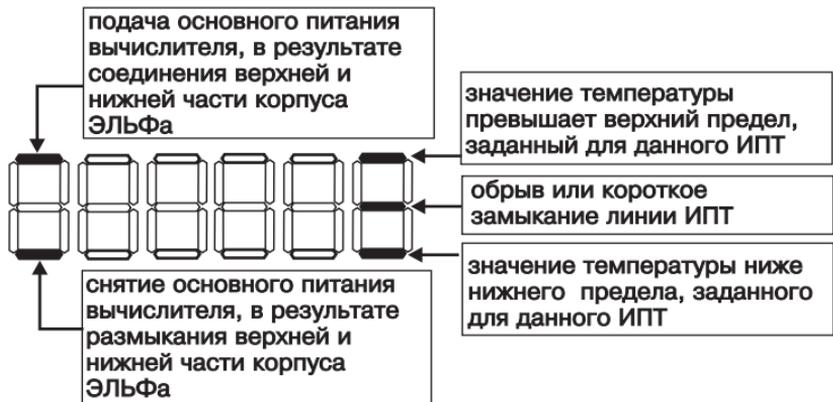
**Рисунок 2.9 - Расшифровка кодов причин нештатной ситуации, отображаемой в поле дополнительной информации, при измерении температуры.**
