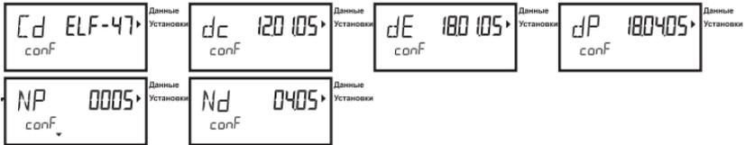
**Рисунок 2.13 - Описание конфигурации вычислителя**
