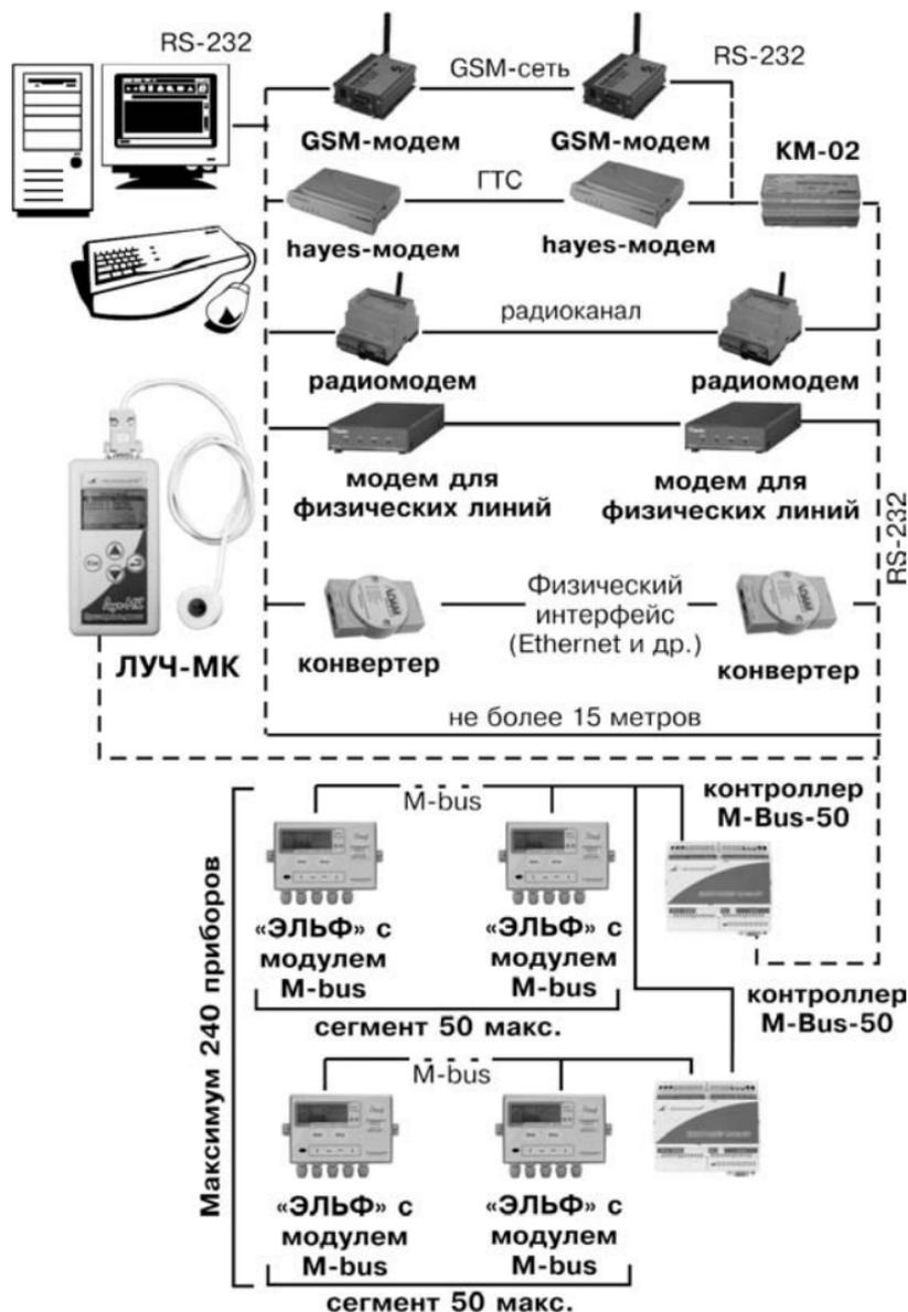
**Рисунок 1.5** Варианты применения интерфейсного модуля M-bus с контроллером M-Bus-50
