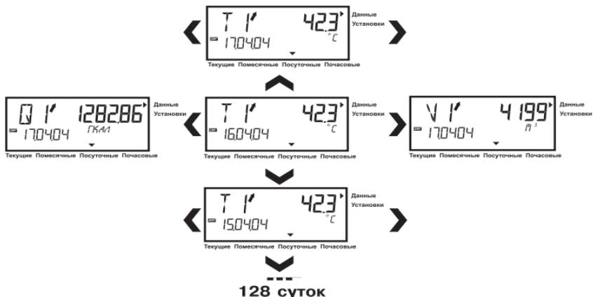
**Рисунок 2.3 - Пример просмотра архивных значений внутри одного архива**
