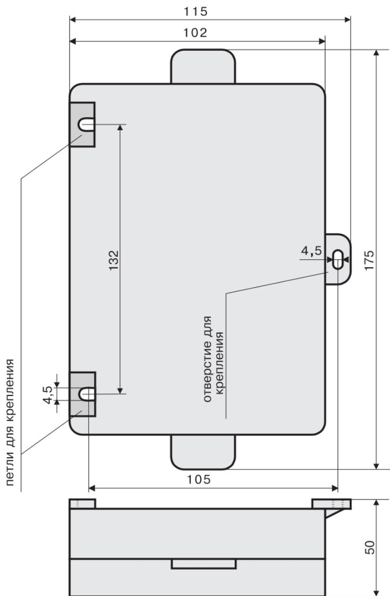
**Рисунок Б.1 – Габаритные и присоединительные размеры вычислителя**
